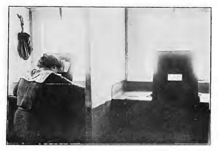
FULMINATE COMPOSITION CHARGING, STEEL SHIELD, WITH WINDOW OF HEAVY GLASS TO THE RIGHT.
